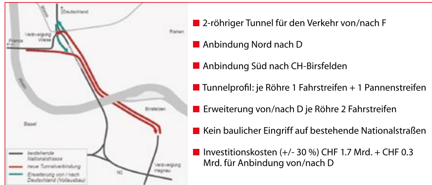
Abb. 1: Engpassbeseitigung Osttangente Basel, neue Tunnelverbindung (rot) Quelle: ASTRA, Faktenblatt-1 MM, ASTRA-N-NP Daniel Kilcher
