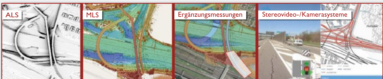
Abb. 4: Die Grundlagendaten wurden aus unterschiedlichen Scan- und Messverfahren erstellt.
